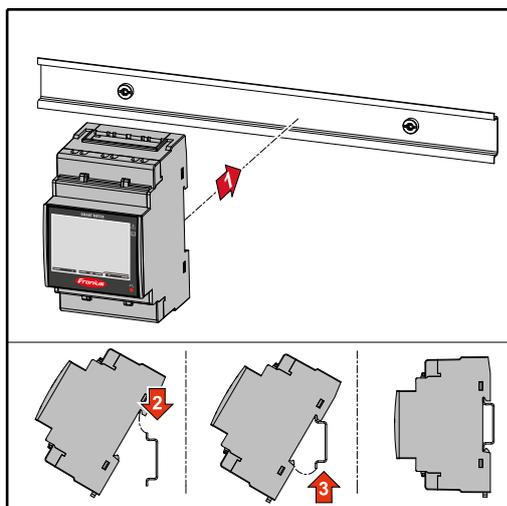
Der Fronius Smart Meter TS kann auf einer DIN-Hutschiene 35 mm montiert werden. Das Gehäuse hat eine Abmessung von 3 Teileinheiten (TE) gemäß DIN 43880.
