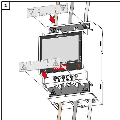
Die Schutzabdeckungen in die Führungen einsetzen und festdrücken.
