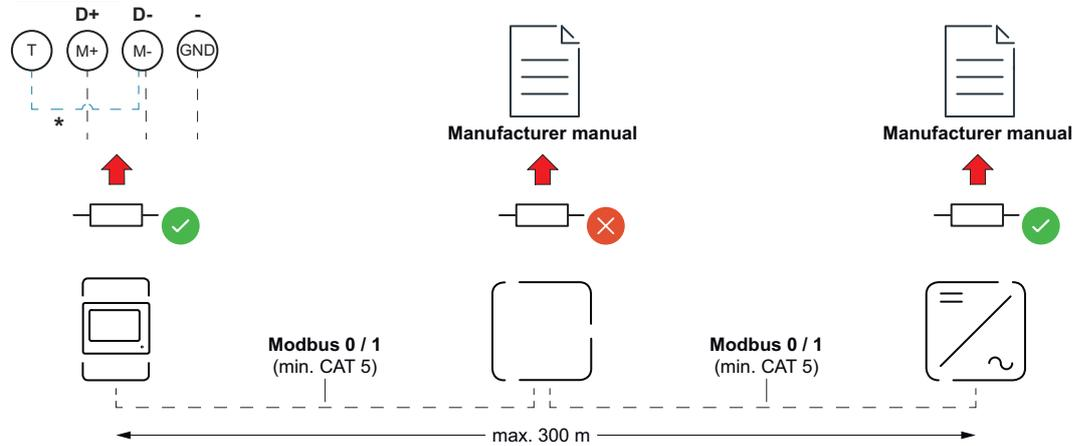
\* Der Abschluss-Widerstand ist im Fronius Smart Meter TS integriert und wird mit einer Überbrückung zwischen den Anschlüssen **M-** und **T** (T = Terminierung) hergestellt.
