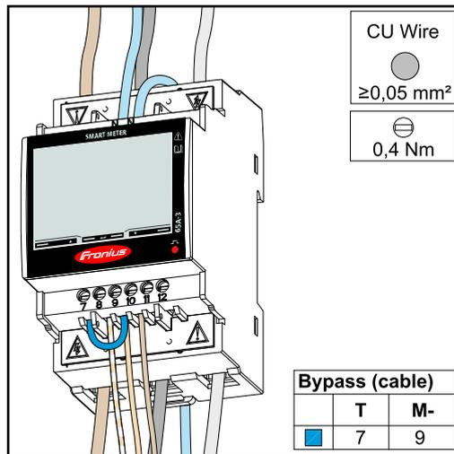
Der Abschluss-Widerstand ist im Fronius Smart Meter TS integriert und wird mit einer Überbrückung zwischen den Anschlüssen **M-** und **T** (T = Terminierung) hergestellt.
