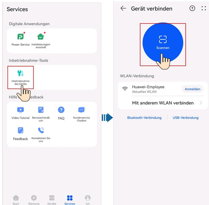
**Schritt 2** Stellen Sie eine Verbindung zum WLAN des Wechselrichters her und melden Sie sich als **Installer** an, um auf den Bildschirm „Inbetriebnahme des Geräts“ zuzugreifen.
