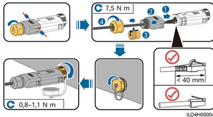
Abbildung 5-44 Installation der Anti-Diebstahl-Komponenten für den Smart Dongle
