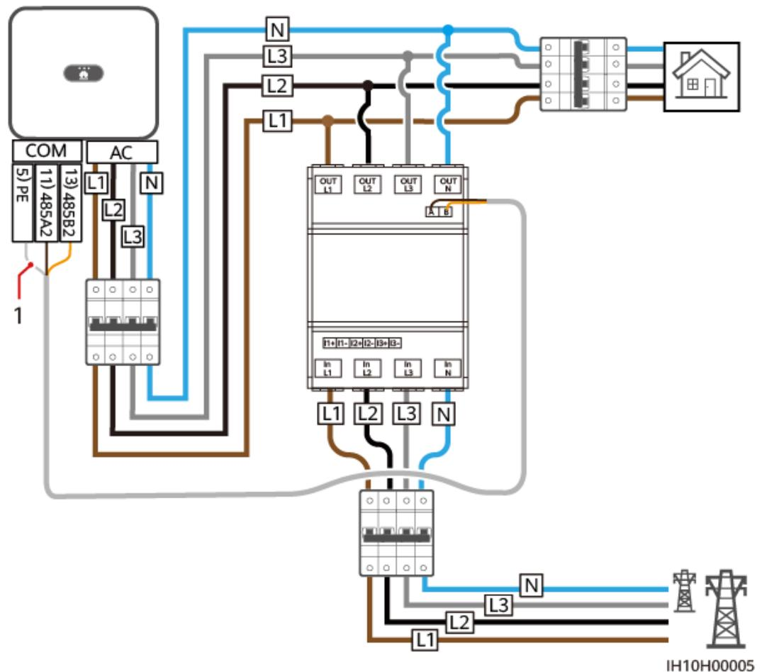
(1) Schirmschicht des Signalkabels
