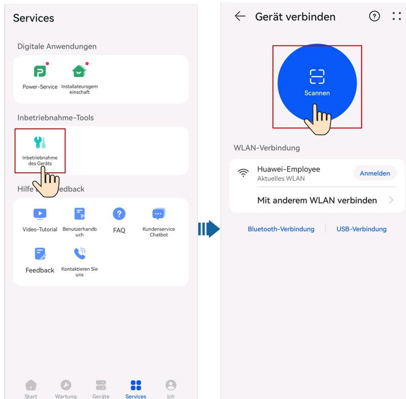
**Schritt 2** Stellen Sie eine Verbindung zum WLAN der EMMA her und melden Sie sich als **Installer** an, um auf den Bildschirm „Inbetriebnahme des Geräts“ zuzugreifen.
