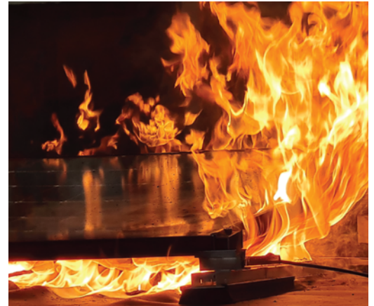
Lichtbogeninduzierter Brand unter Flachdach-Solaranlagen im ZAG-Brandversuchslabor
